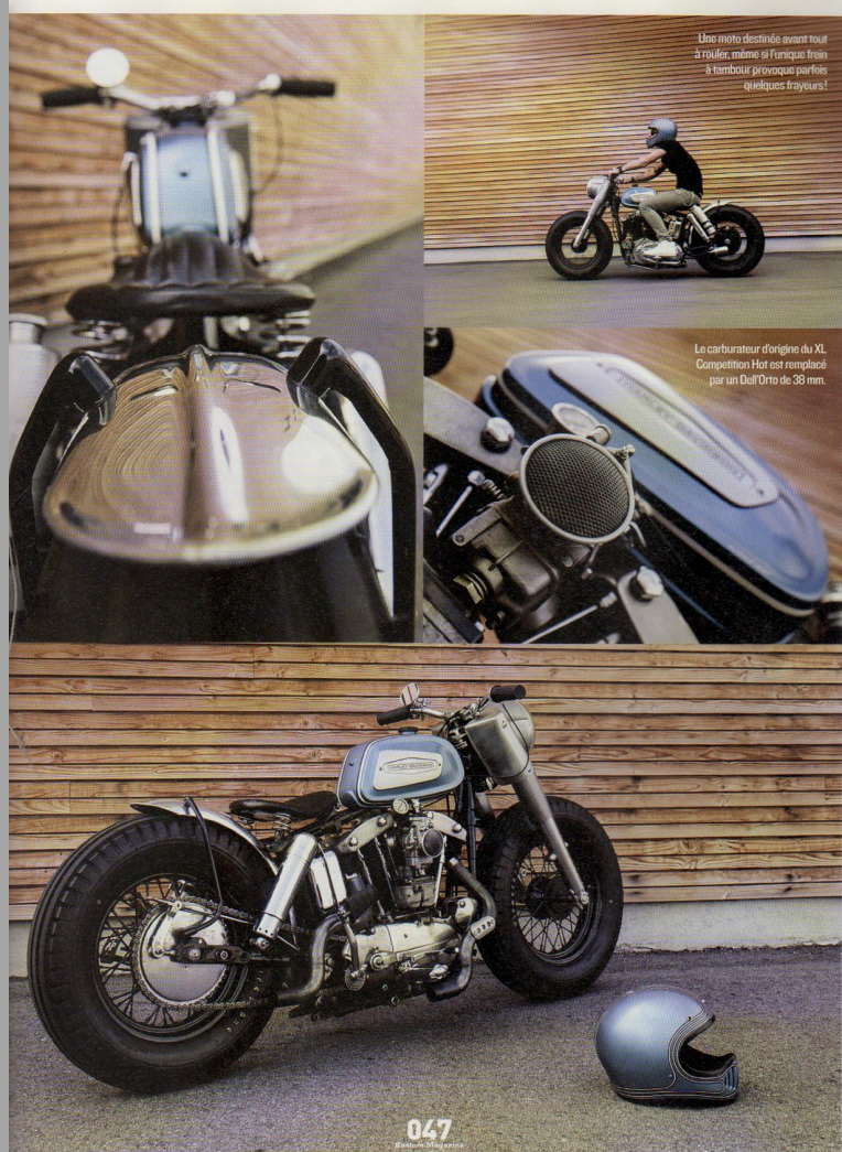
Le réservoir adapté au XLCH est celui qui équipait les ML Rapido, ces petits 125 cc monocylindre 2 temps produits par Harley-Davidson de la fin des années soixante au milieu des seventies.
